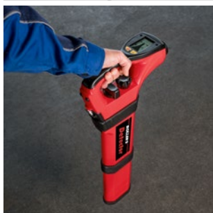
Lokalisering af et kamerahoved med ROLLER'S Detector (tilbehør)
