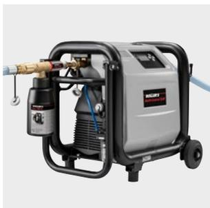
**Leistungsstarke, kompakte, elektronische Spüleinheit mit ölfreiem Verdichter. Zum Spülen mit Wasser oder Wasser/Luft-Gemisch, Desinfizieren, Reinigen, Konservieren von Rohrleitungssystemen. Spülen und Entschlammung von Rohren bis DN 50, Ø 2" mit einem Wasserdruck Rohrnetz bis 1 MPa/ 10 bar/145 psi. Wassertemperatur 5–35° C, Wasserdurchfluss bis 5 m³/h. Betrieb von Druckluftwerkzeugen mit Betriebsdruck bis 0,8 MPa/8 bar/116 psi, Saugleistung bis 230 NI/min.**
