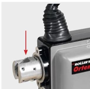
Außerhalb des Gehäuses liegende Spannbacken!
