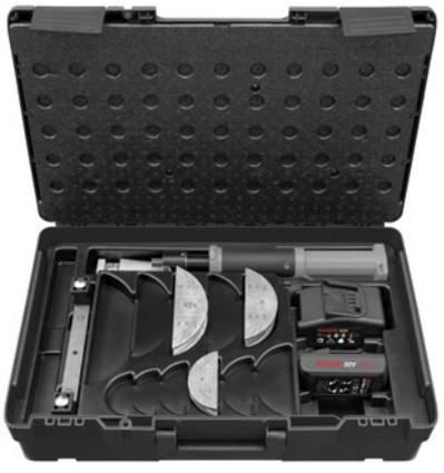
**Kompakter, robuster, ölhydraulischer Hybrid-Rohrbieger für Akku- und Netzbetrieb. Für weiche Kupferrohre Ø 10–22 mm, Ø 3/8–7/8", s ≤ 1,0 mm, weiche ummantelte Kupferrohre Ø 10–18 mm, Ø 3/8–7/8", s ≤ 1,0 mm, Rohre der Pressfitting-Systeme aus nichtrostendem, nickelhaltigem Stahl Ø 15–22 mm, s ≤ 1,2 mm, aus weichem C-Stahl, ummantelt Ø 12–18 mm, s ≤ 1,2 mm, weiche Präzisionsstahlrohre Ø 10–18 mm, s ≤ 1,5 mm. Verbundrohre Ø 14–32 mm. (s = Wanddicke)**
