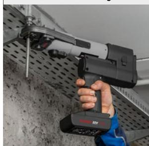
**Universelle, superhandliche, robuste Hybrid-Radialpresse 32 kN, für Akku- und Netzbetrieb, mit automatischem Rücklauf (Zwangsablauf), Pressdruck-Monitoring und Ergebnisanzeige. Anti-Vibrations-System. Für Radial-Pressverbindungen Ø 10–108 (110) mm, Ø ¼–4". Li-Ion 22 V Technology! Akku Li-Ion 21,6 V, 2,5 Ah, für ca. 200 Pressungen mit einer Akkuladung.**
