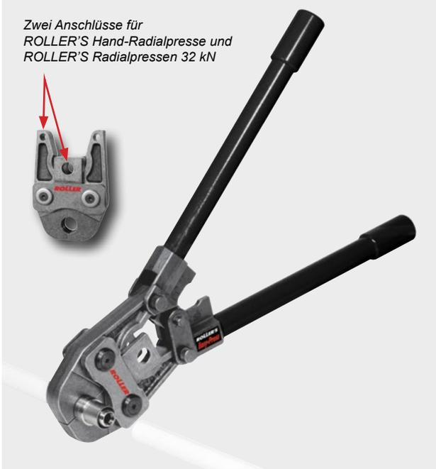
Zwei Anschlüsse für ROLLER'S Hand-Radialpresse und ROLLER'S Radialpressen 32 kN
