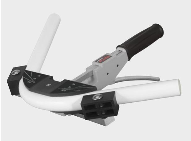
**Praktischer, superhandlicher, superleichter Einhand-Rohrbieger für weiche Kupferrohre Ø 10–22 mm, Ø 3/8–7/8", s ≤ 1,0 mm, weiche ummantelte Kupferrohre Ø 10–18 mm, Ø 3/8–5/8", s ≤ 1,0 mm, weiche ummantelte C-Stahlrohre der Pressfitting-Systeme Ø 12–18 mm, s ≤ 1,2 mm, weiche Präzisionsstahlrohre Ø 10–18 mm, s ≤ 1,0 mm. Verbundrohre Ø 14–32 mm. (s = Wanddicke)**
