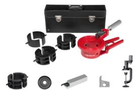
Robustes Rohrtrenngerät aus Metall zum rechtwinkligen Trennen von geschweißten Ablaufrohren / Fallrohren aus Kupfer, Titanzink und nichtrostendem Stahl EN 1124, Ø 50-110 mm.
