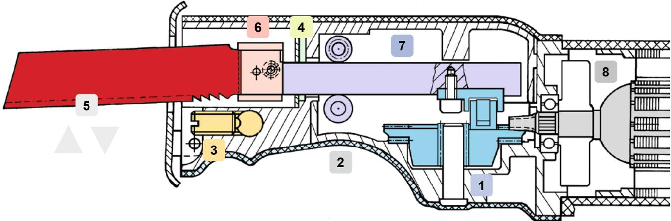
**1** **ANC** *Besonders robuster Oszillationsantrieb erzeugt gleichzeitig Säge- und Orbitalhub. Allseits nadelgelagerter Kurbeltrieb (ANC) reduziert Reibung, Erwärmung und Verschleiß. Dadurch lange Lebensdauer, auch bei extremer Belastung.*
