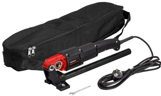
**Handlicher, superleichter, robuster Elektro-Rohrabschneider für Rohre der Pressfitting-Systeme aus nichtrostendem Stahl, C-Stahl Ø 12–28 mm, Kupfer Ø 10–35 mm, Verbundrohre Ø 10–40 mm**
