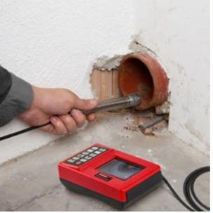
**Besonders kompaktes, leichtes, elektronisches Kamera-Inspektionssystem für brillante Bilder und Videos aus Rohren und Kanälen Ø 40–150 mm, Schornsteinen und anderen Hohlräumen. Mit elektronischer Meterzählung. Für Dokumentation von Videos und Bildern auf SD-Karte. Für Akku- und Netzbetrieb.**
