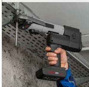
Universelle, superhandliche, robuste Hybrid-Radialpresse 32 kN, für Akku- und Netzbetrieb, mit automatischem Rücklauf (Zwangsablauf), Pressdruck-Monitoring und Ergebnisanzeige. Anti-Vibrations-System. Für Radial-Pressverbindungen  $\varnothing 10-108$  (110) mm,  $\varnothing 1/4-4"$ . Li-Ion 22 V Technology! Akku Li-Ion 21,6 V, 2,5 Ah, für ca. 200 Pressungen mit einer Akkuladung.
